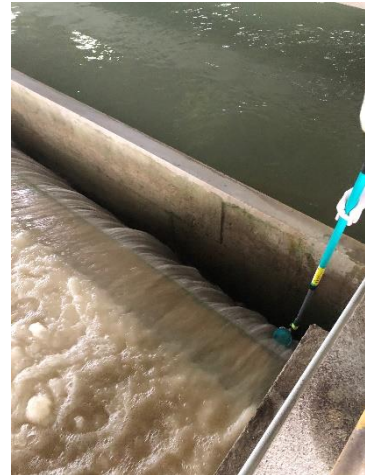
Figura 7-12: Marrja e mostrave të ujërave të ndotura që prodhohen nga termocentrali elektrik Kosova B
